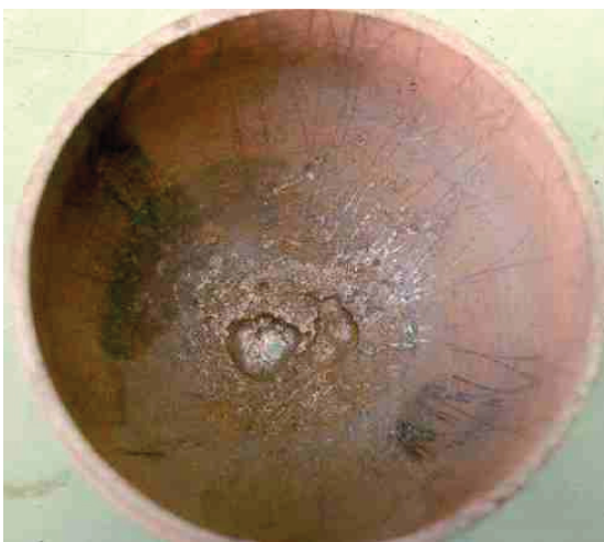
Lochfrass im Boden einer Taucherflasche
